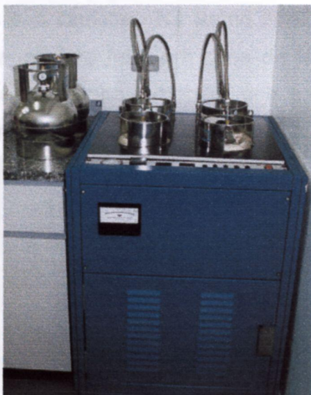
FIGURA 42 - Sistema de lavagem de canister da Xontech.
