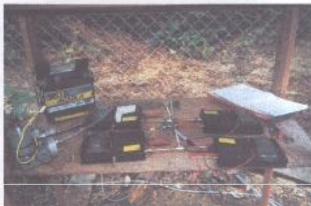
FIGURA 41 - Foto do sistema de amostragem de ar em tubo adsorvente, montado na torre de Santarém.
