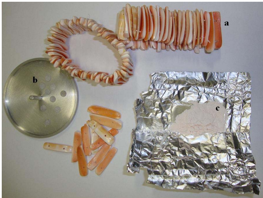
Figura 1: a) Pulseira confeccionada com casca de ostra in natura . b) pastilhas de casca de ostra com Teflon. c) casca de ostra em pó.
