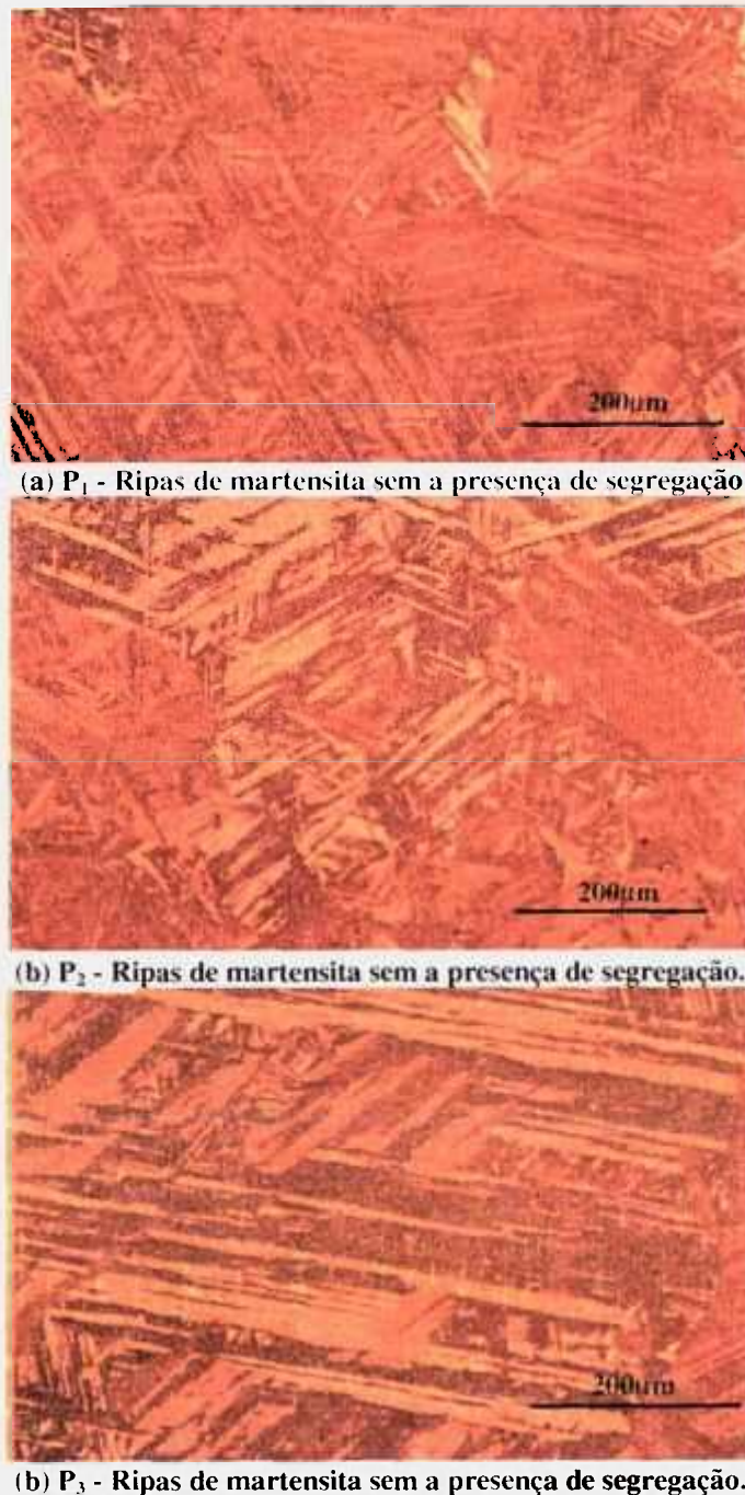
Figura 8 – Micrografia óptica do material homogeneizado e envelhecido nas três posições do lingote. (a) P_1 , (b) P_2 e (c) P_3 . Observa-se, por meio das figuras, que o tratamento térmico de homogeneização reduziu a microsegregação a ponto de não ser mais revelada nas micrografias.
