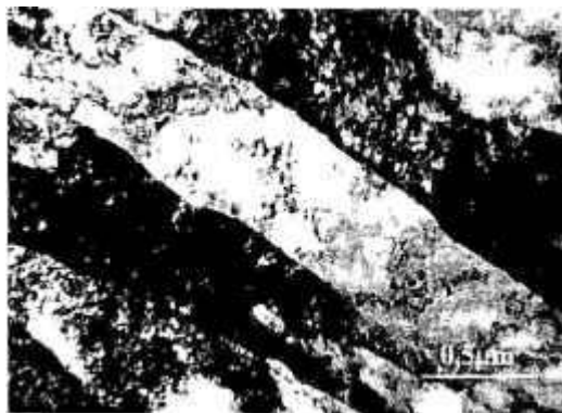
Figura 14 – Micrografia eletrônica de transmissão do material forjado. Ripas paralelas de martensita com alta densidade de discordâncias.
