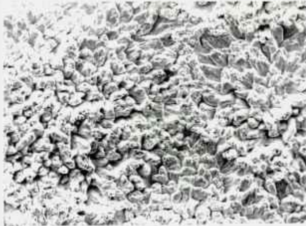
Figura 26: Micrografia eletrônica de varredura da liga Fe-20Cr oxidada a 1100°C por 5 horas.
