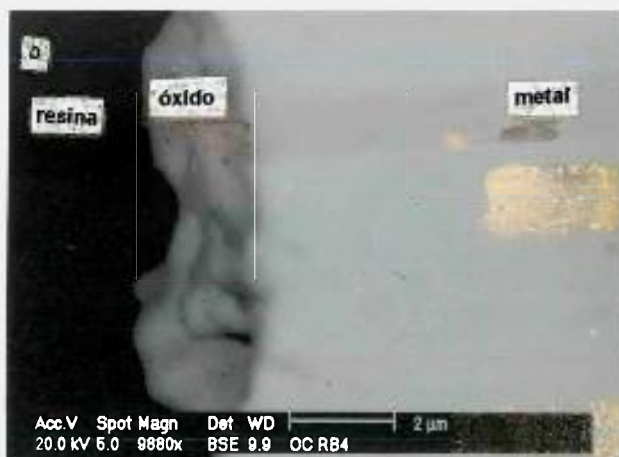
Figura 44: Micrografia eletrônica de varredura da liga Fe-20Cr recoberta com óxido de Y após o 6° ciclo de oxidação à 1000°C por 2 horas. (a) superfície da amostra, (b) secção transversal desta amostra e (c) porcentagem de elemento em função da profundidade da camada.
