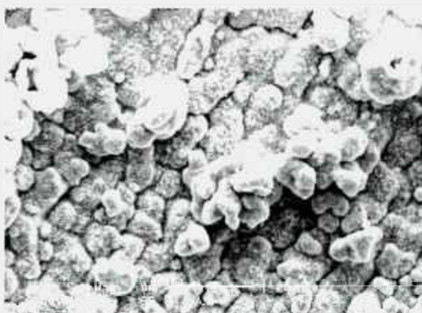
Figura 25: Micrografia eletrônica de varredura da liga Fe-20Cr oxidada a 1000°C por 20 horas.
