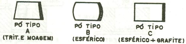
Figura 3 - Efeito da morfologia e do tipo de MTP (pó cerâmico) sobre a geometria originalmente cilíndrica de preformas após a consolidação por Ceracon (100% da densidade teórica) [13].
