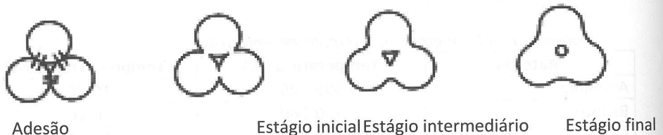
Figura 8.1.1- Estágios do mecanismo de sinterização.
