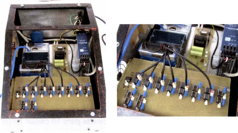
Figura 104. Integração do circuito de amplificação ao sistema de aquisição de sinais C-RIO.
