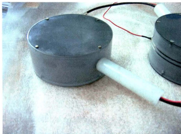
Figura 51. Segundo protótipo de câmara de ionização montado ao lado do primeiro protótipo desenvolvido.
