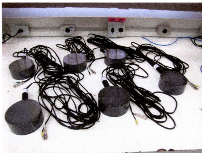
Figura 102. Seis réplicas do protótipo de câmara de ionização apresentado na seção 4.1.7, cada uma com um cabo integrado de 10 m para tensão de polarização e coleta de cargas.
