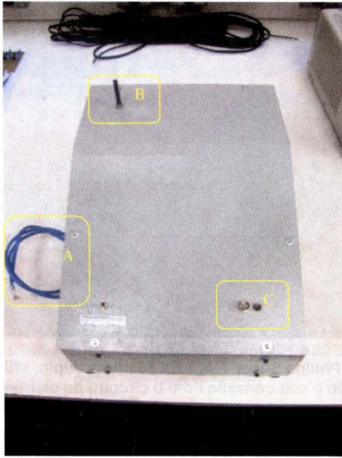
Figura 69. Sistema montado com (A) cabo de comunicação para conexão a computador portátil, (B) controle manual da tensão de saída (potenciômetro) e (C) entrada do eletrômetro com conector coaxial e plugue banana para saída de tensão de polarização para câmara de ionização.
