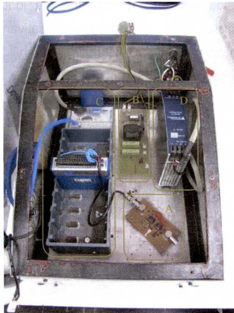
Figura 68. Segunda montagem do eletrômetro em gabinete metálico blindado, composta por (A) amplificador, (B) Fonte de polarização da câmara de ionização, (C) sistema de aquisição C-RIO da National Instruments e (D) fonte de alimentação do sistema
