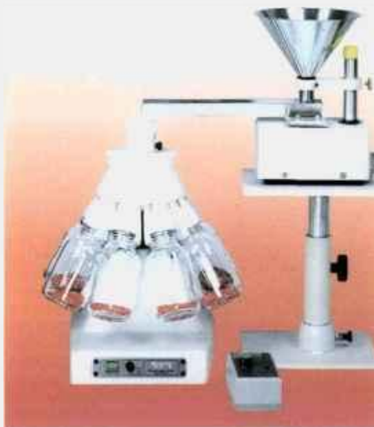
FIGURA 3.1 – Amostrador Centríflugo similar ao utilizado.
