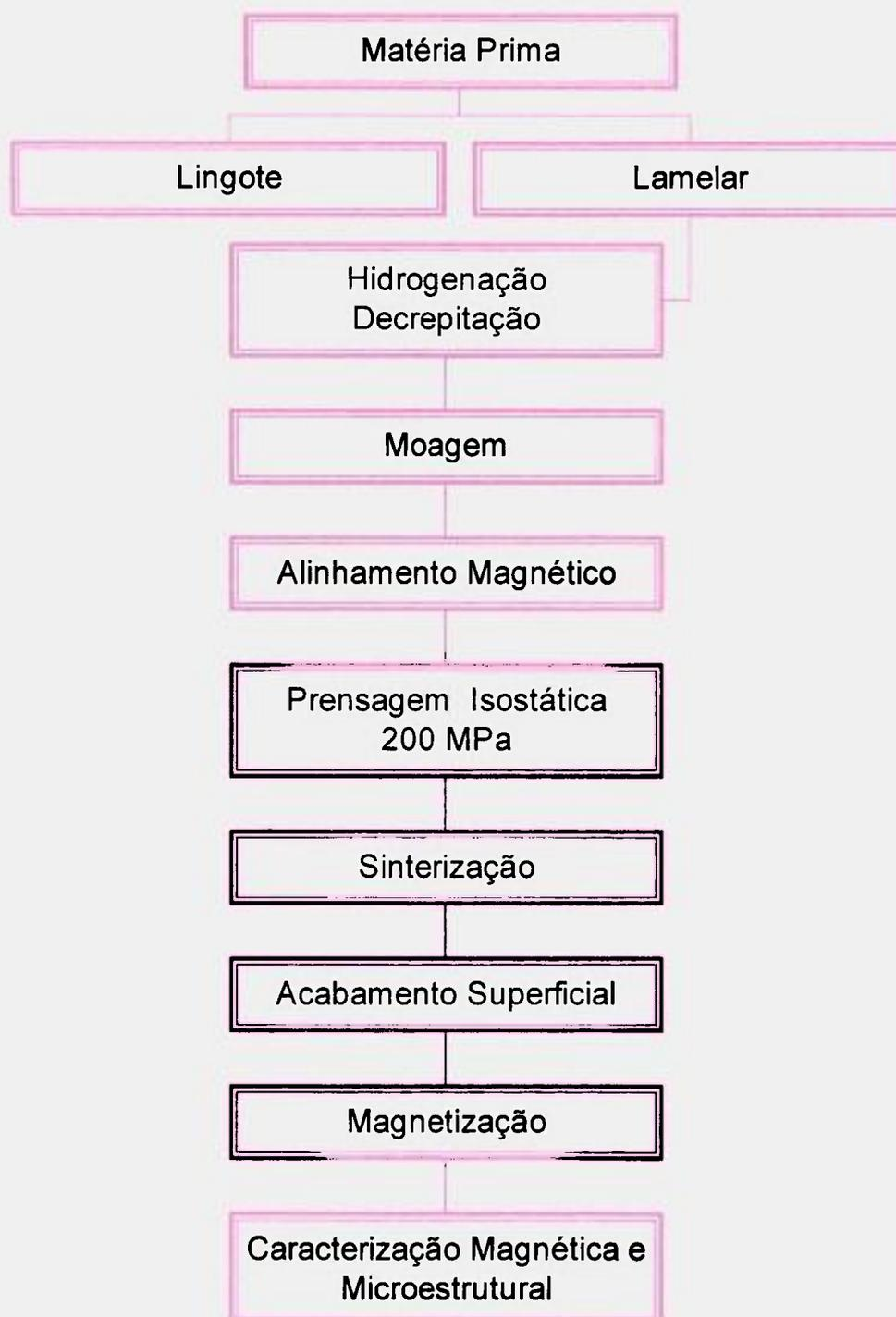
Figura 3.1. Fluxograma das etapas de obtenção dos ímãs (Nd,Dy)-Fe-B-Nb utilizando o processo HD.
