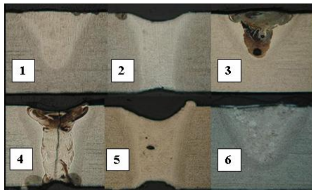
Figura 5 – Microscopia óptica da seção transversal das soldas feitas
