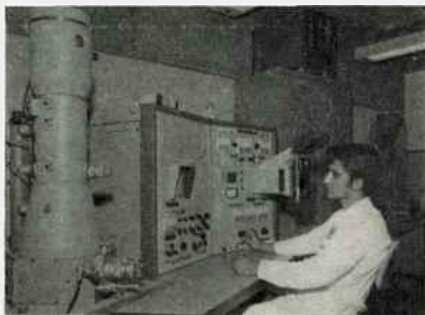
Fig. 4 — Microscópio eletrônico de varredura Stereoscan S4 instalado na Divisão de Metalurgia Nuclear, utilizado no estudo da morfologia de pós de UO_2 e no exame da superfície das pastilhas.
