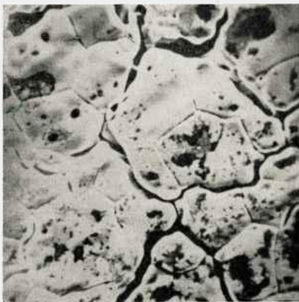
Fig. 7 — Superfície obtida por fraturamento de pastilhas de UO_2 -S, evidenciando grande susceptibilidade à trincas. 1085 aumentos, em microscópio de varredura. (Reduzida a 2/3 no clichê).
