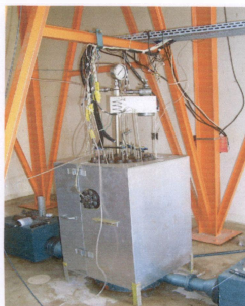
(b) Modelo do vaso isolado termicamente
