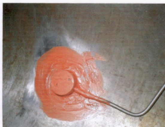
(b) Instalação protegida por borracha de silicone
