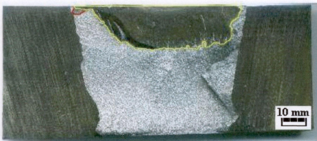
FIGURA 65 - Superfície de fratura da trinca T4 após o choque térmico
