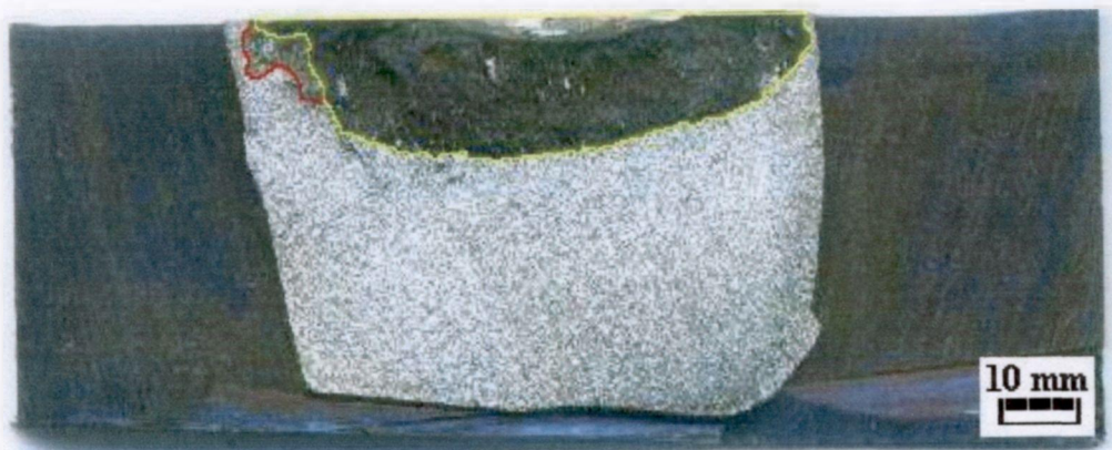
FIGURA 64 - Superfície de fratura da trinca T3 após o choque térmico
