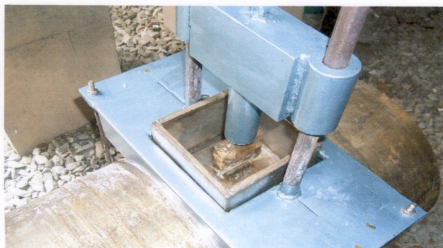
FIGURA 17 - Peso posicionado sobre a cunha após o impacto
