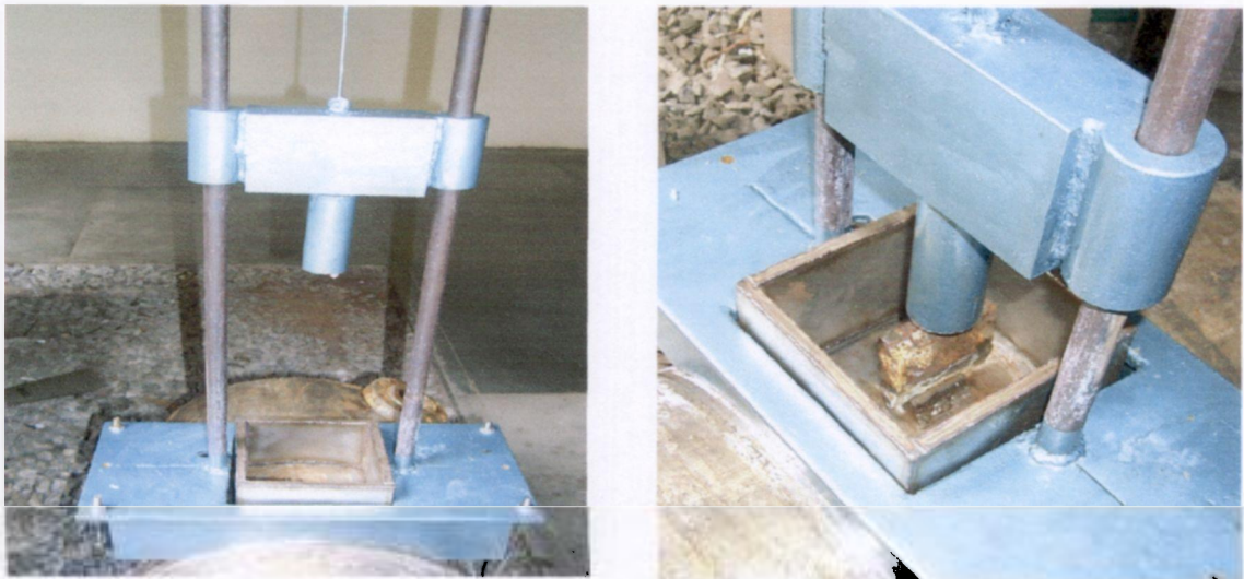
FIGURA 15 - (a) sistema de queda de peso montado sobre o modelo do vaso de pressão, (b) vista do peso posicionado sobre a região do entalhe
