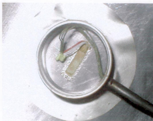
(a) Extensômetro dentro da proteção de aço inoxidável
