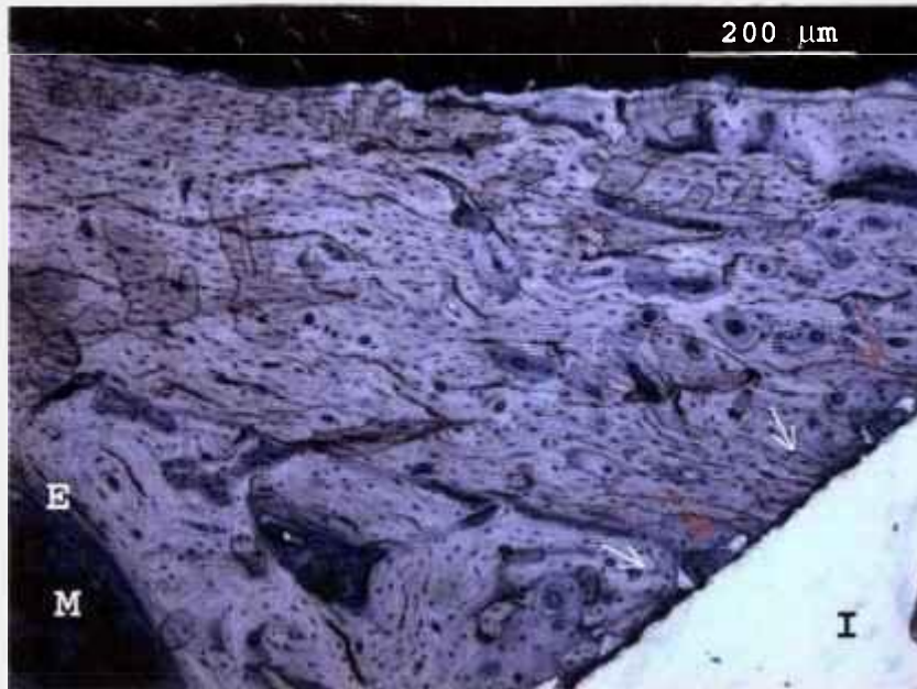
Figura 19: Micrografia óptica mostrando o remodelamento ósseo em torno do implante de nitreto de silício (I) na região da cortical cirúrgica. As setas vermelhas e brancas estão indicando a interface contendo um tecido não mineralizado e um contato ósseo direto, respectivamente. Pode-se observar o endóstio (E) e a cavidade medular (M)
