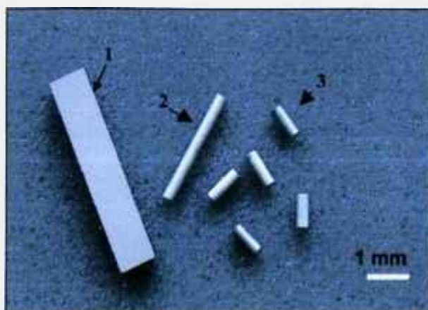
Figura 2: Amostras de nitreto de silício: 1) na forma inicial (barra); 2) após retífica e 3) após retífica e corte (nas dimensões específicas para o teste “ in vivo ”)
