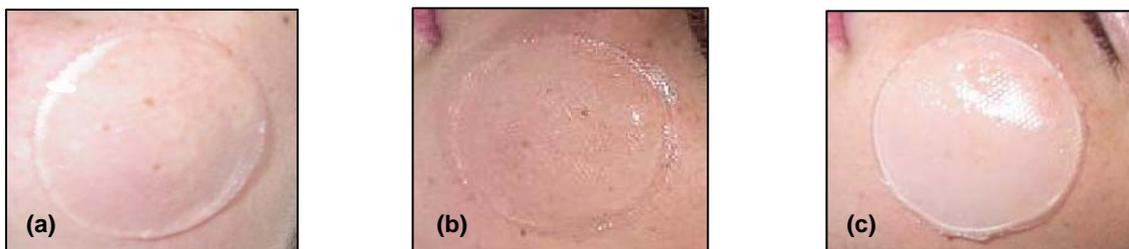
**Figura 1.** Demonstração de aplicação de matrizes de hidrogel: (a) hidrogel de PVP+Glicerol; (b) hidrogel de PVP+PEG+Ágar; (c) hidrogel de PVP+Glicerol+Óleo de Girassol.
