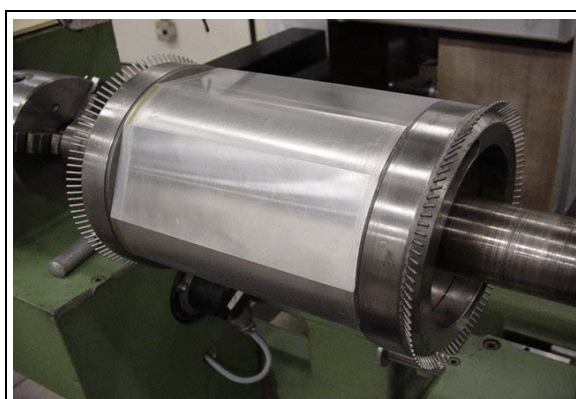
Figura 3. Mandril cilíndrico com cinco faces planas, fabricado para servir de molde na bobinagem unidirecional.
