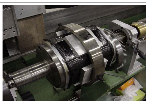
Figura 4. Mandril montado com placas planas e anel de contenção externo para garantir a compactação do composto nas regiões planas.
