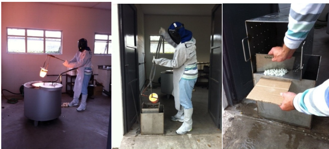
Figura 1: Seqüência de operação no forno a gás I. Fusão da frita, II. Vertimento em água, III. Coleta da amostra
