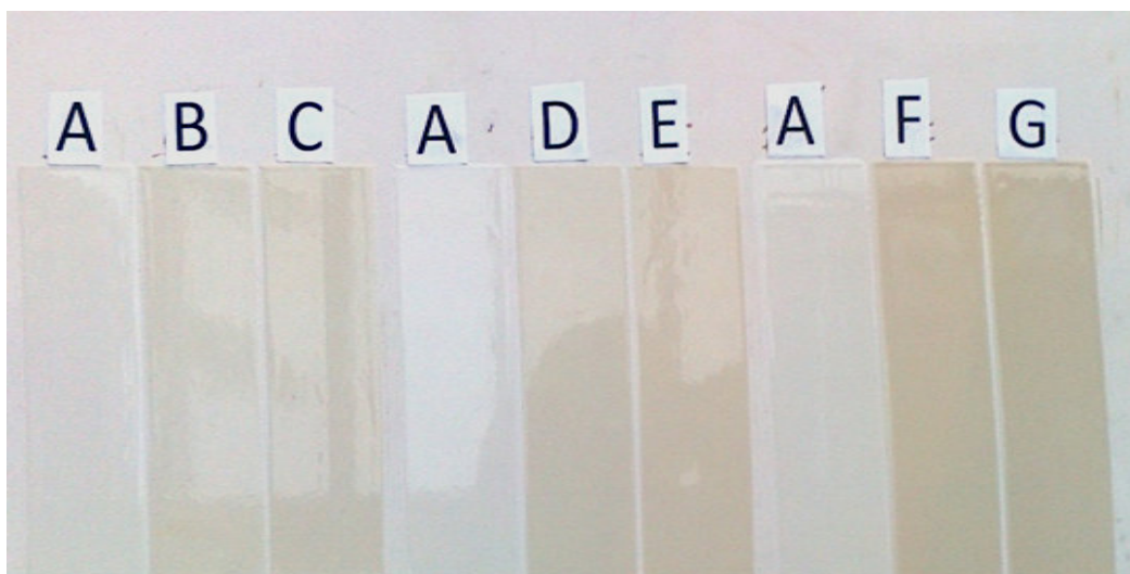
Figura 2: Vidrados obtidos e aplicados em cerâmica monoporosa queimados em Forno Túnel Industrial com ciclo de 1190°Cx42min
