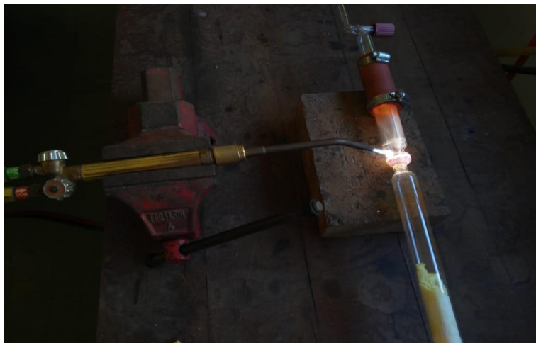
Figura 1: Processo de selamento de cadinhos de quartzo utilizando maçarico.
