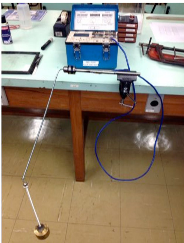
Figura 7. Arranjo experimental para a aplicação de torques controlados na barra de torque.
