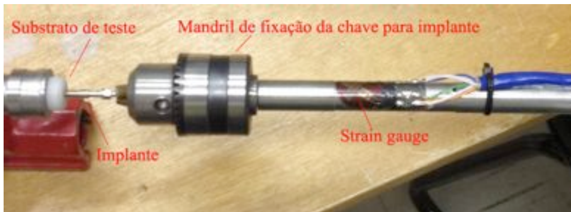
Figura 4. O strain gage colado sobre a barra de torque, para a realização de ensaios de medição de microtorque.
