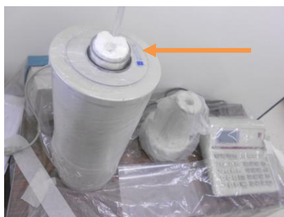
Fig.4: Câmara de ionização modelo Capintec15W. Destaque para o suporte para as medidas.
