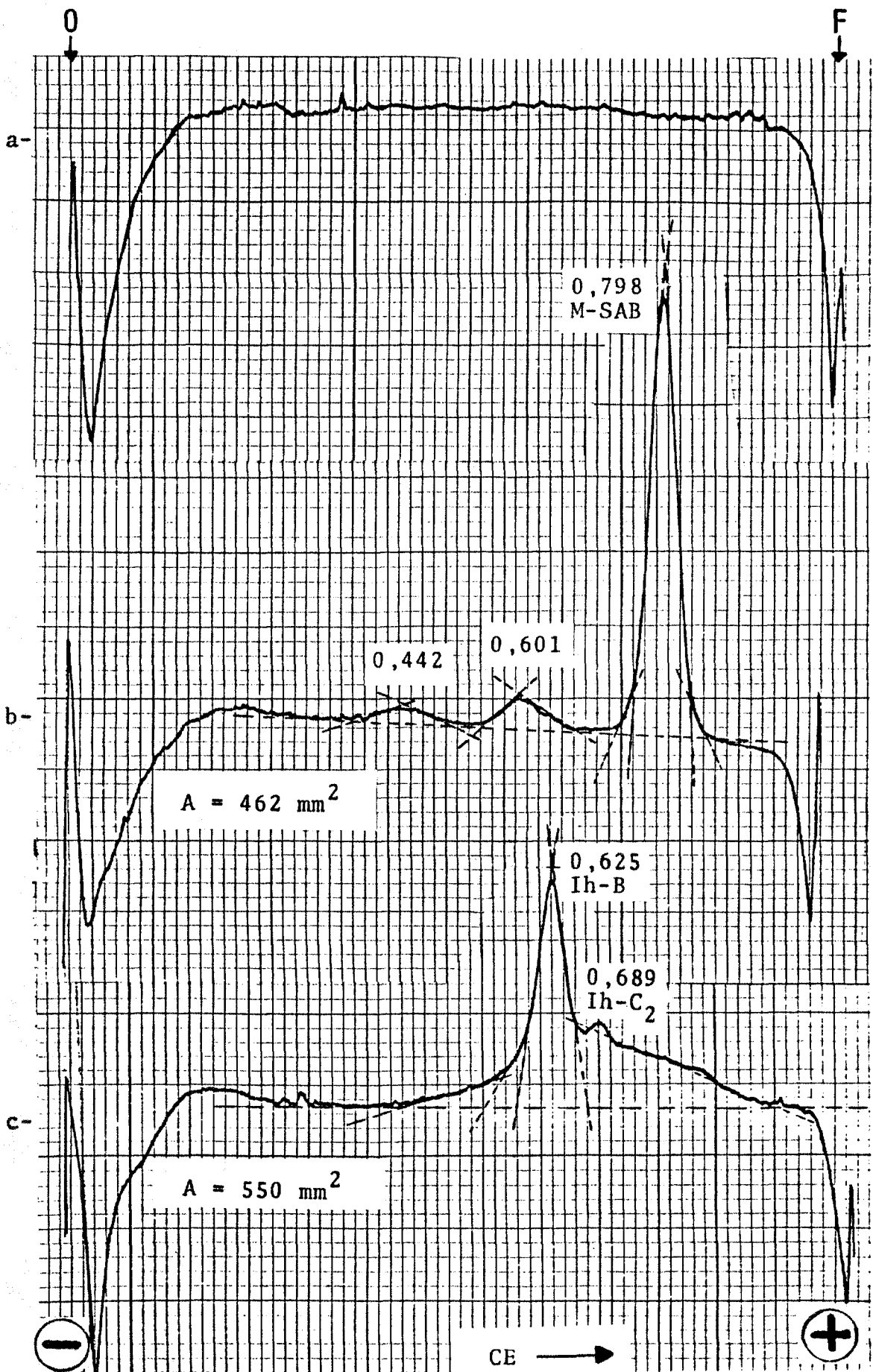
FIGURA 15 - Densitogramas obtidos após EGPA analítica, com 7% de acrilamida. Os triângulos tracejados em b - e c - delimitam a área total (A), pela qual se quantifica a proteína contida no gel. a- gel branco. b- SAB (100 µg). c- HCH-IPEN (120 µg).
