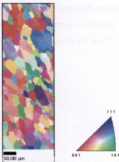
Figura 3.4.9: Mapa da figura de pólo inversa para uma chapa de aço baixo carbono contendo 2% em peso de silício, recozida a 760°C e, posteriormente, laminada com redução de 9% em espessura. Ao lado, código de cores definindo as orientações de cada grão.
