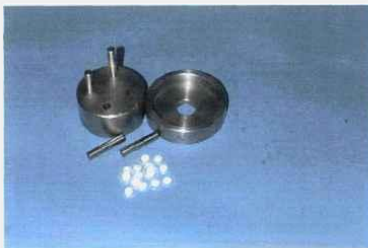
FIGURA 3.2 – Molde fabricado em aço inoxidável para prensagem de pastilhas.
