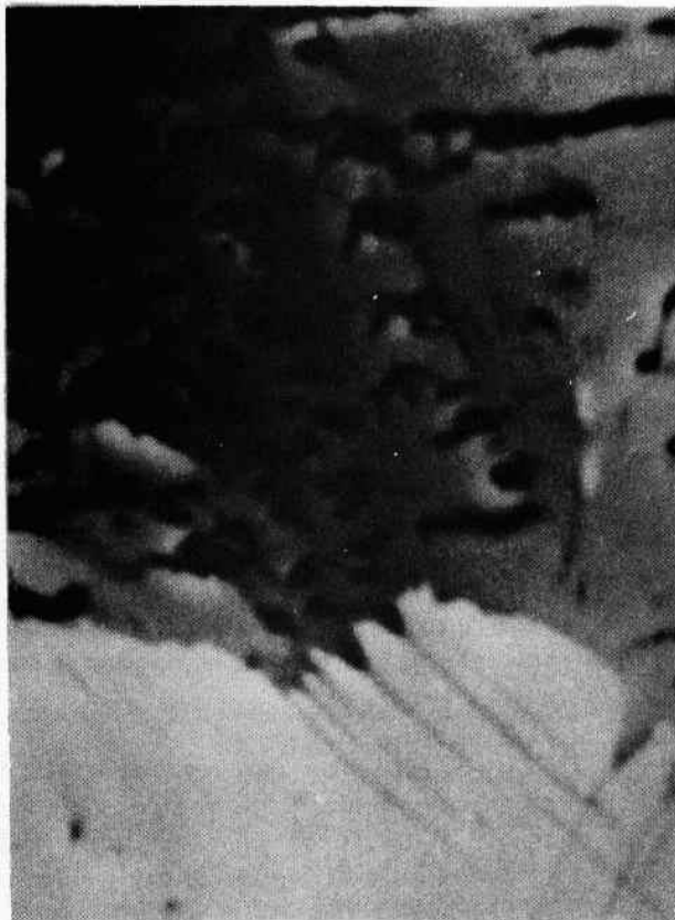
Figura 30 – Camada de Óxido, Formada, Durante 40 minutos a 600^{\circ}\text{C} e 100 mmHg de Oxigênio, em Nióbio Recozido. Nota-se a Presença de Plaquetas e Linhas de Poros. Aumento 3000X
