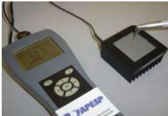
Figura 4 - Medidor de potência e energia
