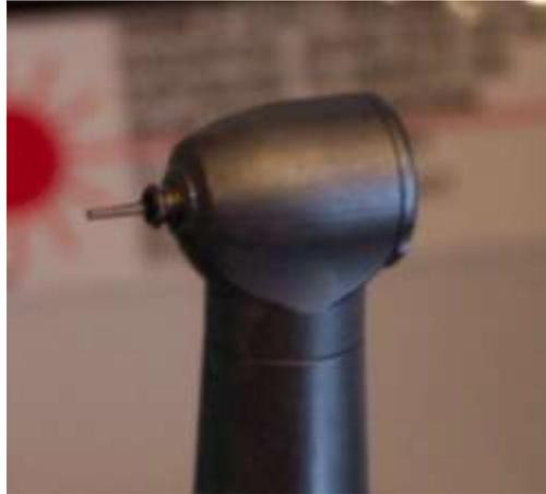
Figura 3 - Peça de mão com ponta de safira do Laser de Er,Cr:YSGG
