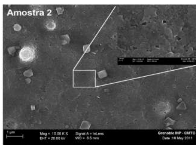
Figura 2: Micrografias obtidas em MEV de filmes de LSM depositados sobre o substrato SS444 pela técnica de ESD, sintetizados a 800°C por 2 h em fluxo de ar.
