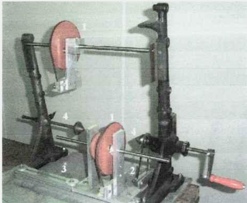
FIGURA 4.5 Equipamento desenvolvido e utilizado para enrolamento do focalizador magnético.
