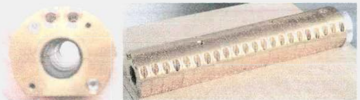
FIGURA 5.41 – Sistema de colimação magnética PPM construído neste trabalho: (a) vista frontal e (b) vista lateral.
