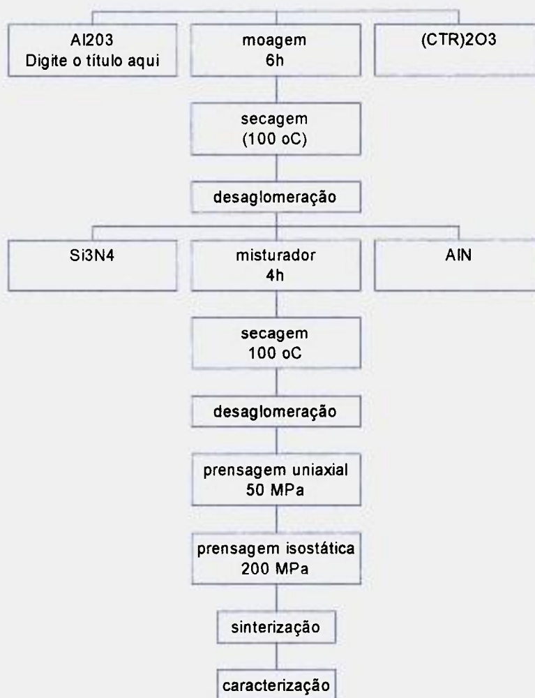
Figura 3.3 – Fluxograma esquemático da preparação das amostras.
