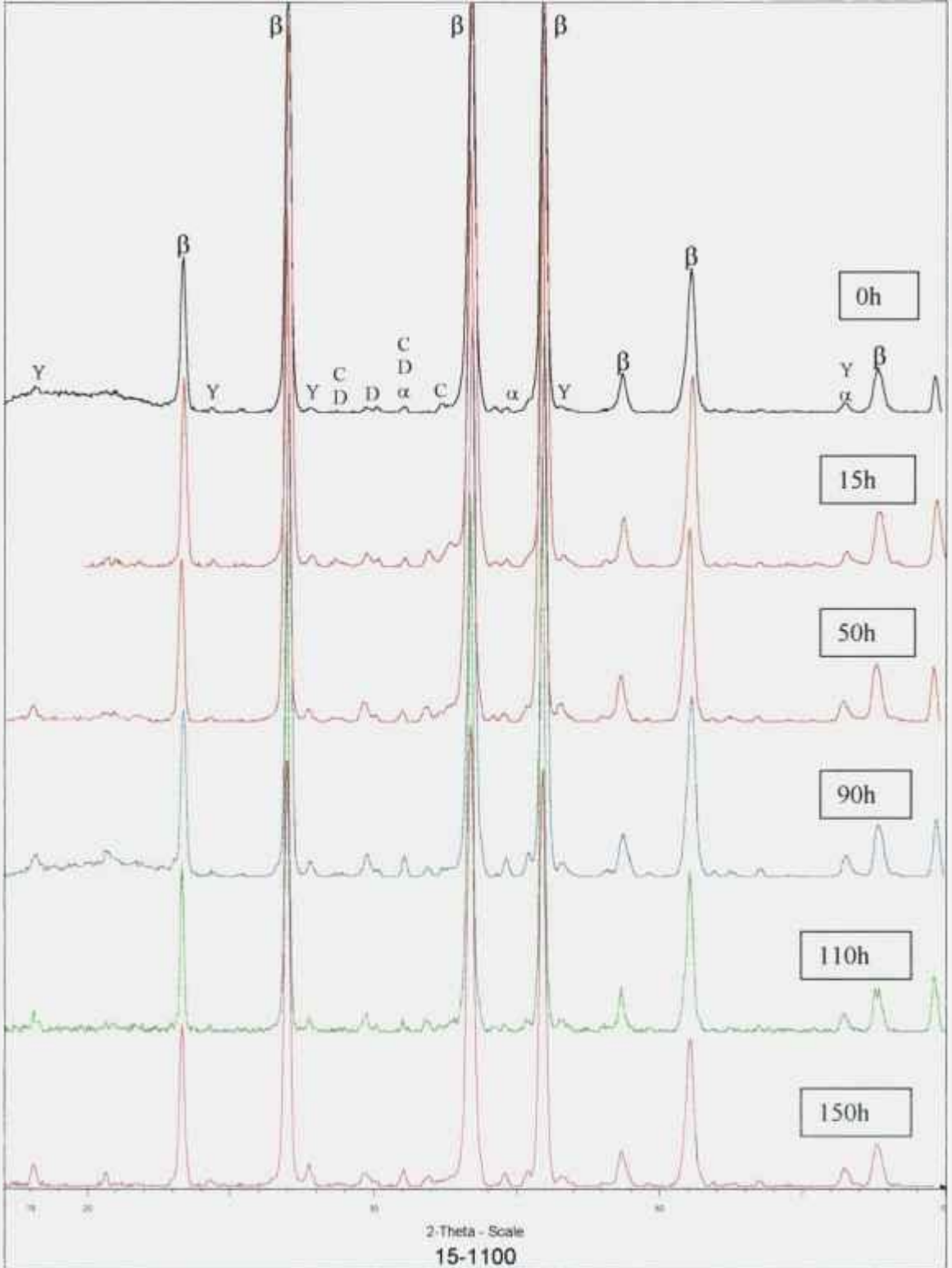
Figura 4.37 – Difratogramas de raios X das amostras com 15 % em eq. de Al, após tratamentos térmicos a 1100°C.
