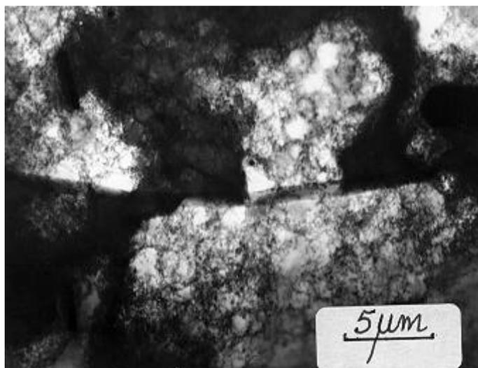
Figura 3 - Micrografia eletrônica por MET (200kV) da liga de alumínio 6063 recozida (400°C, 60 minutos), torcida ciclicamente (2.8%, 20 ciclos) e tracionada.
