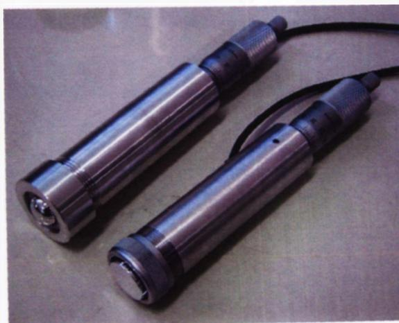
FIGURA 5.3 - Foto das mini-câmaras de extrapolação de janela curva e de janela plana.
