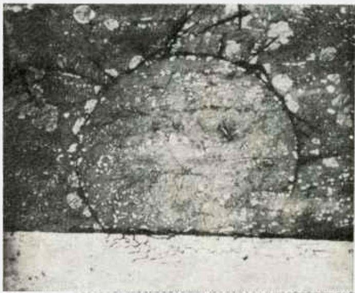
Fig. 9 — Início da corrosão de tântalo por plutônio sob uma bôlha de gás.
