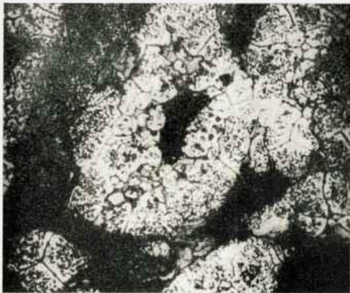
Fig. 8 — Penetração de plutônio num corpo esponjoso de tântalo.
