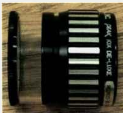
Figura 3.10 Lente de aumento da Bishop Graphics Inc com divisões de 0,1 mm e magnificação de 10X
