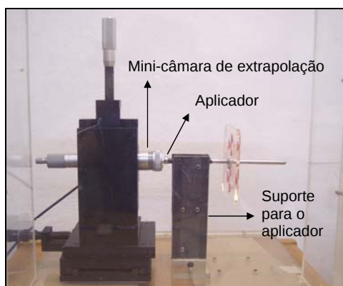
Figura 3. Arranjo experimental utilizado na calibração dos aplicadores.
