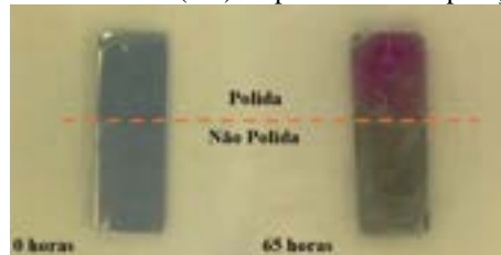
Figura 2. Imagens da placa com metade da superfície polida mecanicamente (remoção da superfície) e exposta a agar-agar com NaCl e fenolftaleína.
