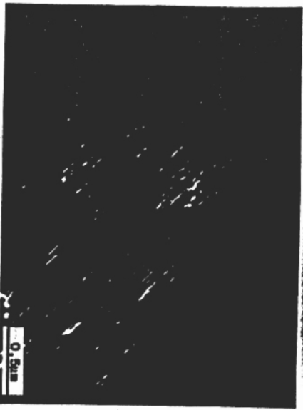
Fig.6 (b) - Micrografia Eletrônica de Transmissão do Mar s/Co no estado envelhecido, 400°C - 15 horas. Precipitação fina presente (Imagem em campo escuro)
