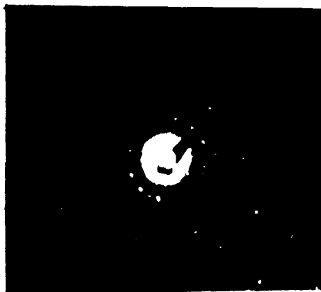
Figura 8 :Padrão de difração eletrônica da lâmina fina de uma amostra tratada termicamente a 600°C por 18 horas.
