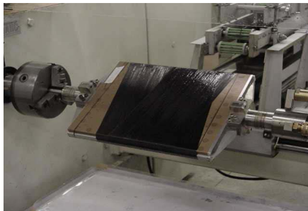
Figura 1- Etapa do processo de bobinagem para fabricação das placas.
