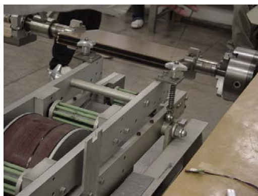
Figura 2- Etapa de impregnação da fibra de carbono.
