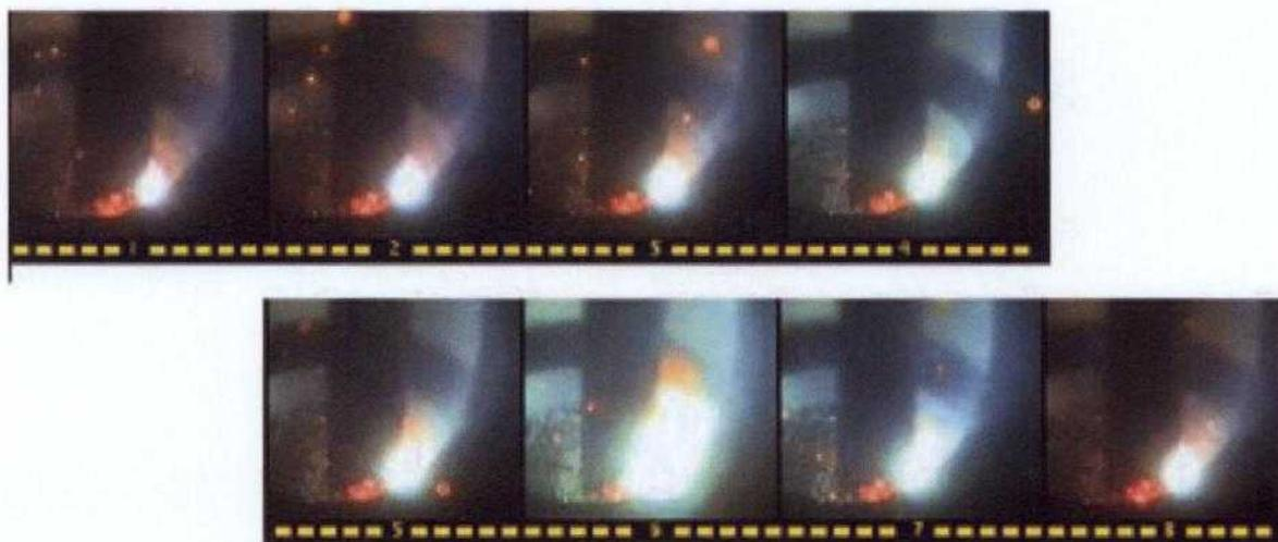
Figura 5.4 - Seqüência de fotogramas mostrando o arco elétrico, curto circuito, flash de luz que ocorre durante a extinção do arco elétrico e retorno ao arco elétrico.
