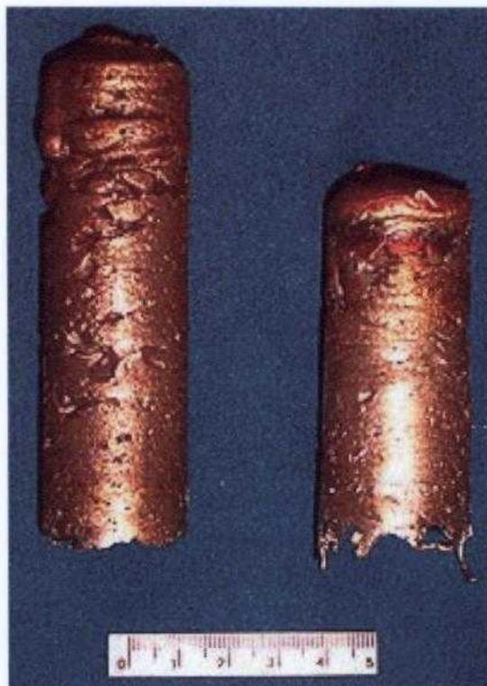
*Figura 5.6 - Lingotes obtidos nas fusões 1 e 2 da tabela IV.*
