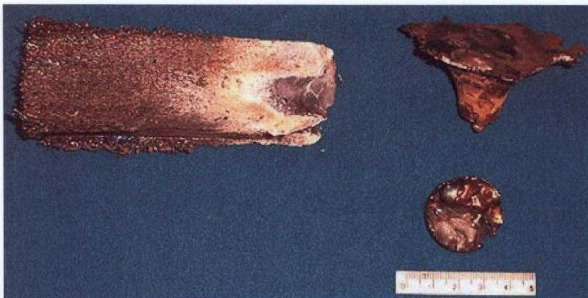
*Figura 5.8 - Fotografia do eletrodo, lingote e massa do entupimento do dispositivo funil-lingoteira da fusão 4, tabela 4.5.*
