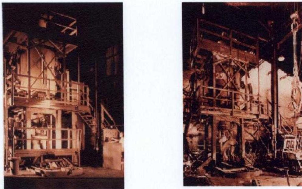
Figura 3.9. Fotos de um forno VAR antes e depois da explosão devida à entrada de água na lingoteira, que causou a fatalidade de um operador em 1955, e feriu outros três, POULSEN<sup>[40]</sup>.
