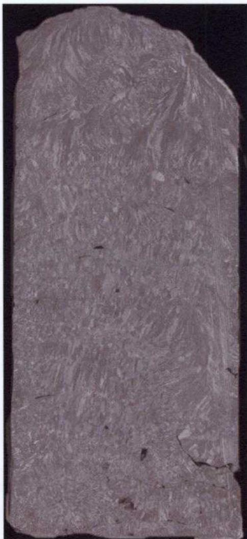
Figura 5.15 – Macrografia do lingote de aço inoxidável.
