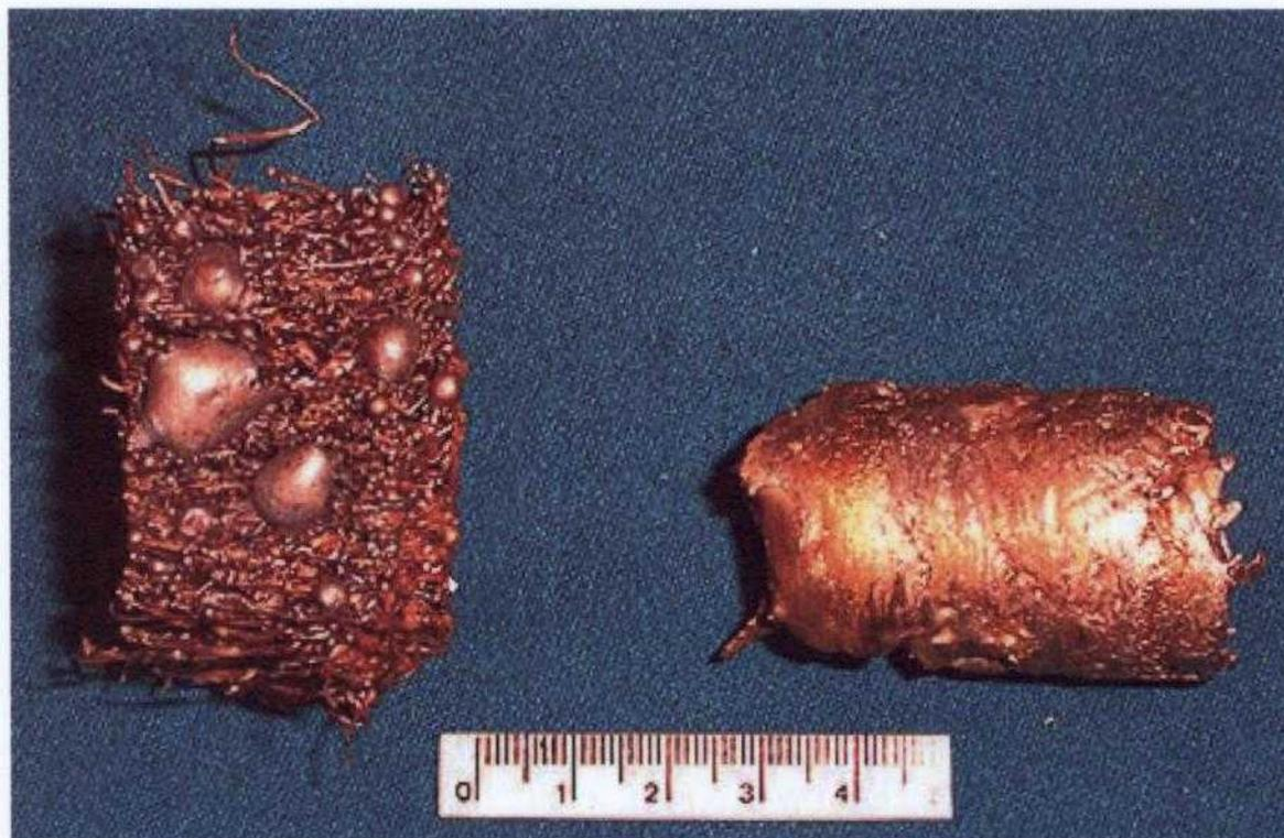
*Figura 5.7 - Fotografia da extremidade do eletrodo e do lingote obtido na fusão 3.*
