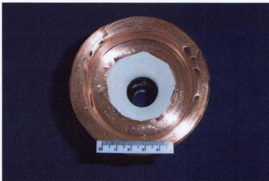
*Figura 5.3 – Fotografia da vista superior do funil, observa-se a pintura com tinta a base de Nitreto de Boro para a fusão do eletrodo de cavacos de Zircaloy prensado.*
