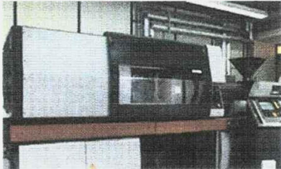
FIGURA 19 – Injetora sendo utilizada para preparação de artefatos plásticos
