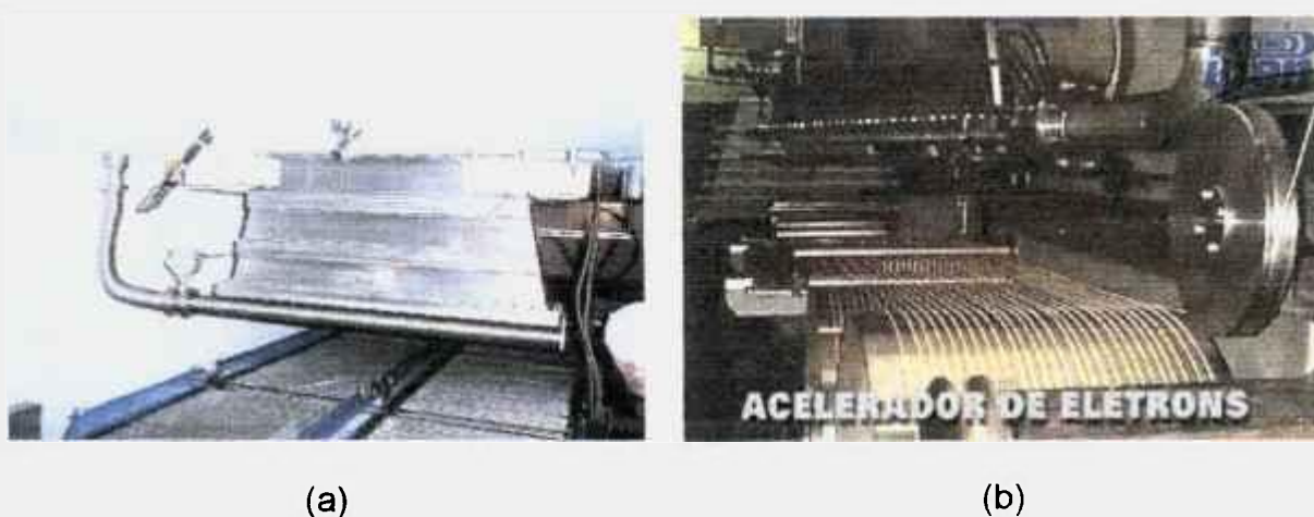
FIGURA 36 – Ilustração de esteiras utilizadas para transporte de material (a) e de um alimentador automático sendo utilizado para fios elétricos (b), visando a passagem sob um sistema superior de feixe de elétrons
