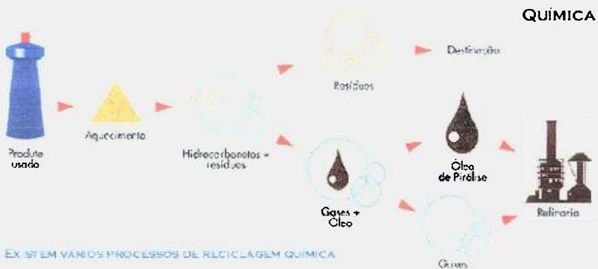
FIGURA 28 – Representação esquemática de um processo de reciclagem química
