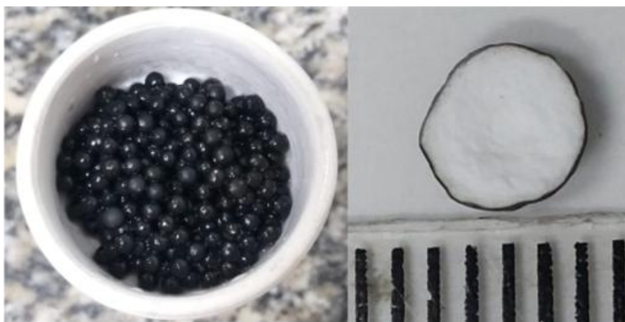
Figura 1: Catalisador Pd/Al 2 O 3 (a distância entre as barras corresponde a 1 mm).
