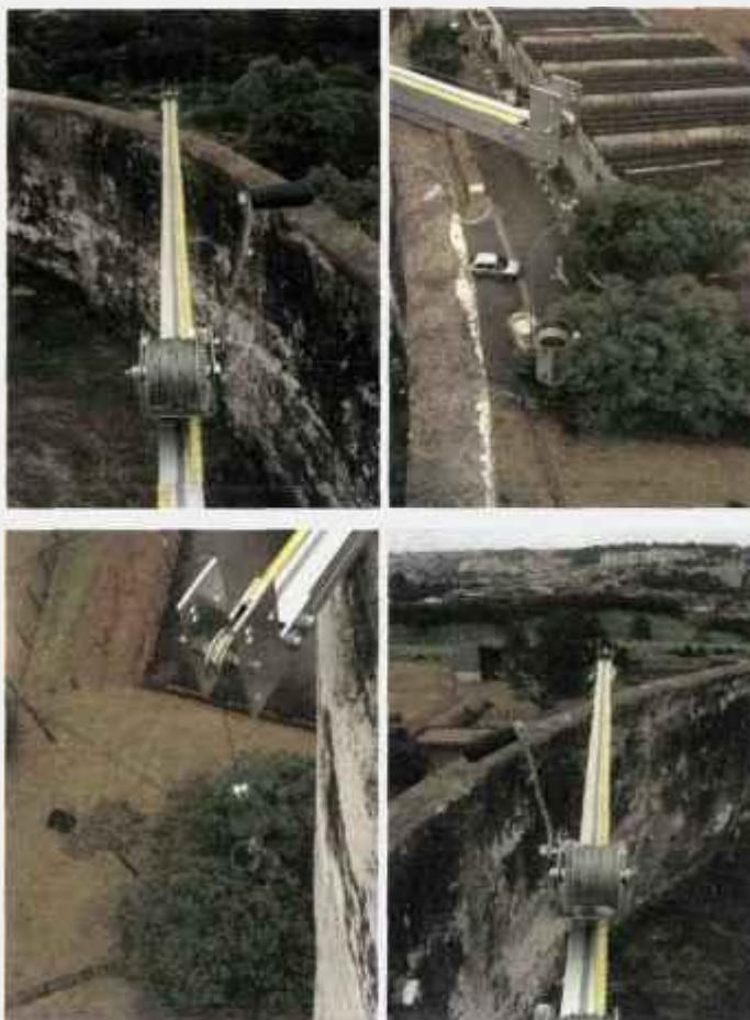
FIGURA 21 – Sistema para o deslocamento da fonte e do detector na coluna industrial.
