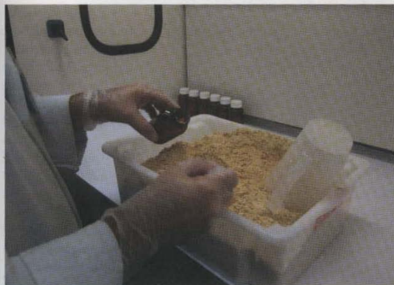
25 Parte do processo para obtenção de Material de Referência Certificado (MRC), como forma de garantir a qualidade de processos químicos, calibração e controle de instrumentos e análises. Utilizada espécie de peixe corvina ( Micropogonias furnieri ). Foto: Edson Moreira.
