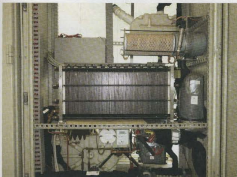
21 Módulo de célula a combustível do tipo PEMFC de 5 kW de potência elétrica com tecnologia 100% brasileira, em cooperação com a empresa Electrocell. Crédito: Ana Paula Freire.
