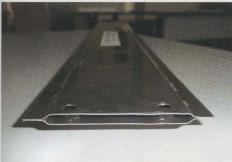
23 Detalhe do revestimento em aço inox que compõe a barra de controle do Reator IEA-R1, desenvolvida e produzida no IPEN. Crédito: Marcello Vitorino.
