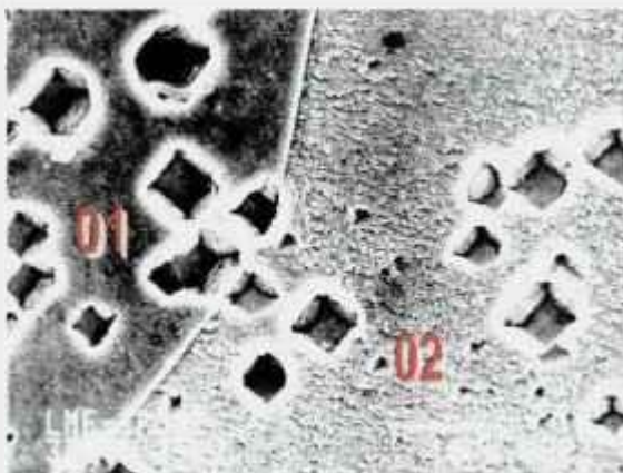
Fig. 4.13 – Micrografias obtidas por MEV, mostrando o grão 01 com microcavidades na orientação (100) e o grão 02 com microcavidades com orientação (111).
