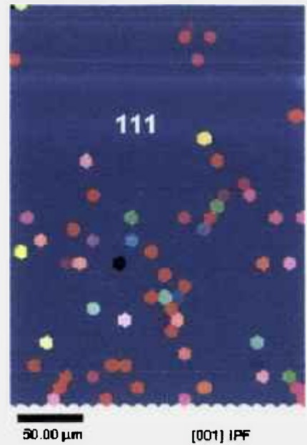
Fig. 4.22 – Padrão de Kikuchi para amostra de Fe-3%Si (superfície) com compressão a quente (02 passes) utilizando MIO (2ª varredura no mesmo grão da figura 4.21).
