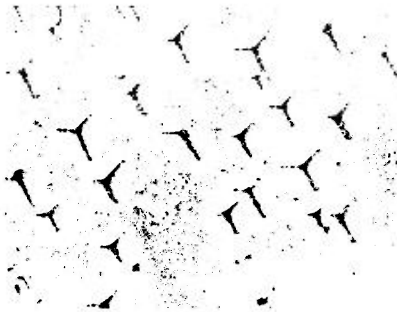
Fig. 4.3 – Micrografia obtida por MEV, mostrando microcavidades na orientação (111).
