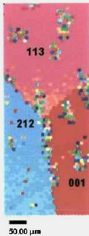
Fig. 4.19 – Padrão de Kikuchi para amostra de Fe-3%Si (superfície) com compressão a quente (02 passes) utilizando MIO (1ª varredura).
