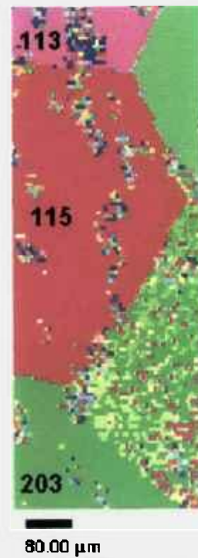
Fig. 4.20 – Padrão de Kikuchi para amostra de Fe-3%Si(superfície) com compressão a quente (02 passes) utilizando MIO (2ª varredura).
