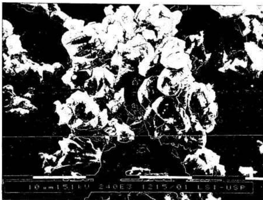
Figura 42- Micrografia do pó da liga obtida nas condições do experimento 3 (MEV).
