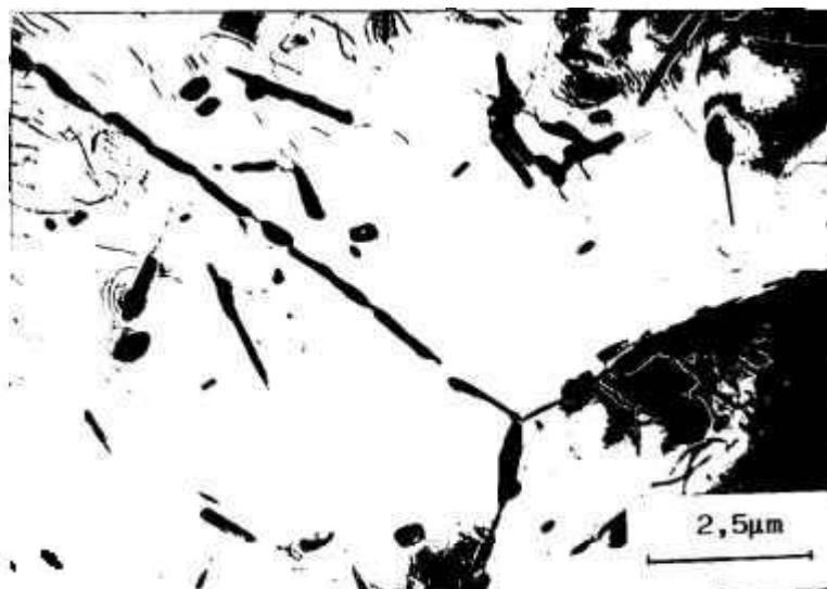
Figura 31: Liga EMVAC 600 nacional, laminada (90% redução em espessura), solubilizada e envelhecida a 720°C por 100 horas. Micrografia eletrônica (MET), onde observa-se precipitação acicular no interior do grão.
