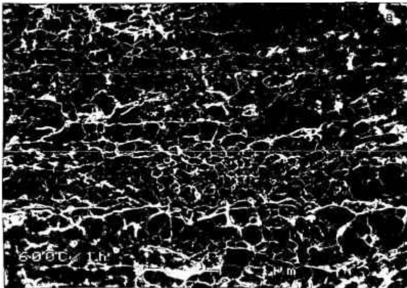
Figura 17: Liga EMVAC 600 nacional laminada (90% de redução em espessura), recozida a 600°C por 1 hora e ensaiadas em tração. a) Micrografia eletrônica (MEV), mostrando a fractografia da liga com aumento na quantidade de dimples, o que caracteriza a ductilidade. b) Gráfico tensão (Kg/mm 2 ) x deformação (mm) para a liga.
