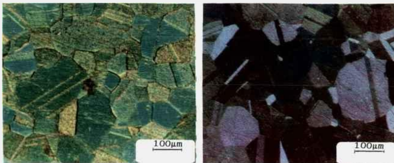
Figura 20: Liga EMVAC 600 nacional laminada (90% redução em espessura), "solubilizada" a 1100°C. a) Microestrutura obtida por MO da amostra solubilizada por 15 minutos, aspectos gerais de grãos grosseiros. b) Microestrutura obtida por MO da amostra solubilizada por 30 minutos, aspectos gerais de grãos grosseiros.
