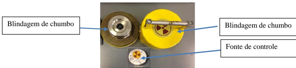
FIG. 2: Fonte de controle de  $^{90}\text{Sr}+^{90}\text{Y}$  e sua respectiva blindagem.
