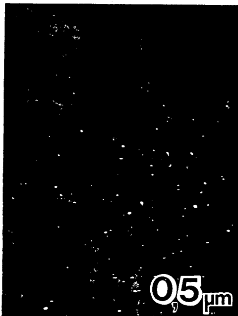
Fig.6 : Micrografia Eletrônica (MET) do Mar s/ Co no estado envelhecido (480C/7 horas). Precipitados finos no interior de um grão (Imagem em campo escuro)
