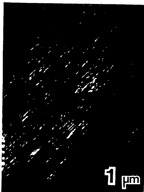
Fig.8 : Micrografia Eletrônica (MET) do Mar s/ Co no estado envelhecido (480C/15 horas). Precipitação fina presente (Imagem em campo escuro).
