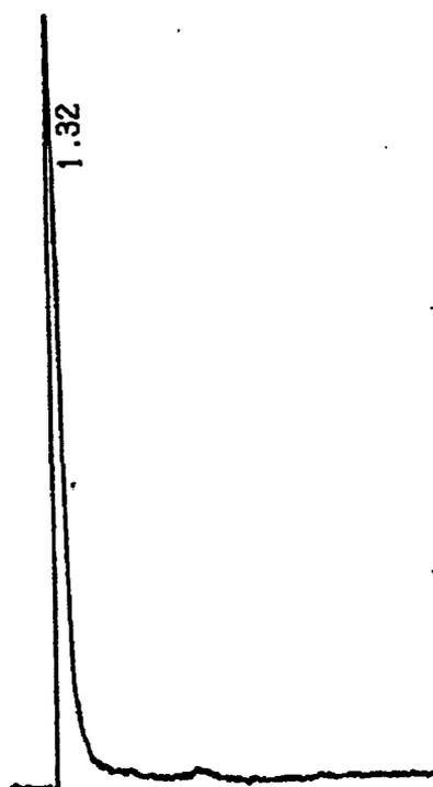
**FIGURA 16** - Cromatograma de CLAE do AMI irradiado durante 7 minutos (1,62  $\mu\text{g}$  Sb), monitorado em 330 nm durante 20 minutos.
