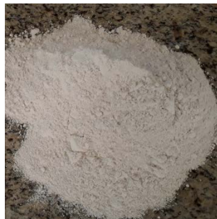
Figura 5: Pó de PTFE obtido após micronização
