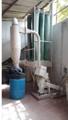
Figura 4: Micronizador para obtenção do pó de PTFE
