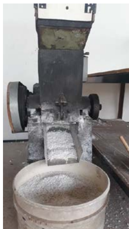
Figura 2: Moinho utilizado na moagem do PTFE
