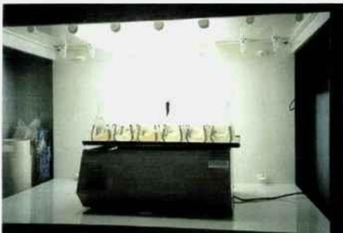
Figura 8: Teste de toxicidade crônica para Selenastrum capricornutum
