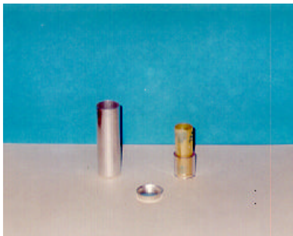
Figura 1. Coelho de Alumínio de Irradiação e Conjunto de Filmes Plásticos
