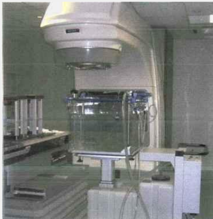
FIGURA 5 – Observa-se na figura um objeto simulador sendo irradiado com câmaras de ionização.
